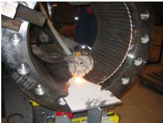
Figuur 10*: Oplassen van een inlet/outlet met een 30 mm band.
