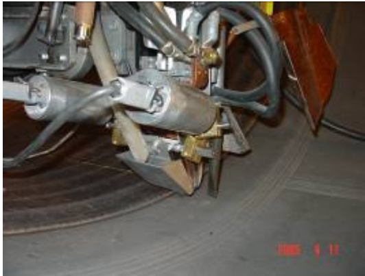
Figuur 8*: Bandlaskop 125-ES1-300 met magnetische besturing
