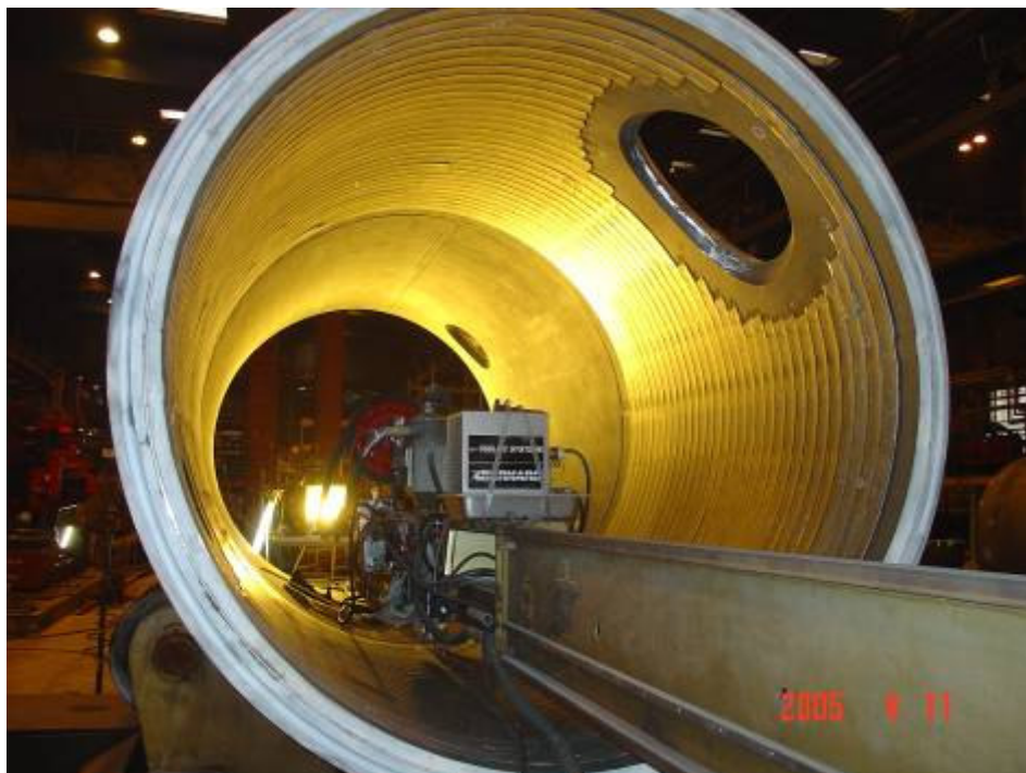
Figuur 7*: Oplassen van een drukvat met Soudotape 24.12 L Nb (90 x 0,5 mm) en Record EST 136
